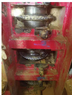
图 18 刀具磨损情况
