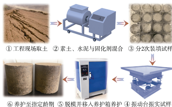
图5 测试试样制备流程
