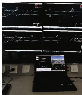
图4 列车自动驾驶半实物仿真测试平台 Figure 4 HIL Simulation Test Platform for ATO
