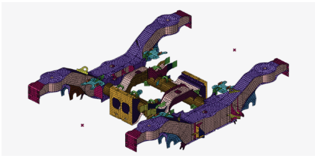
图 5 转向架构架有限元模型 Figure 5 Finite element model of bogie frame
