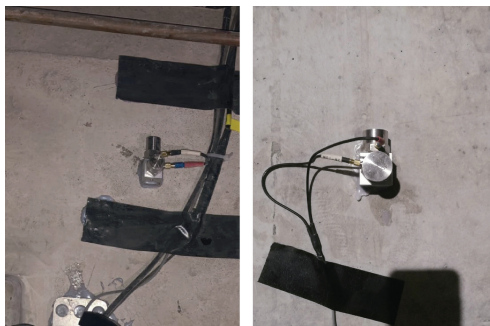
(a) 道床加速度测点 (b) 隧道壁加速度测点
