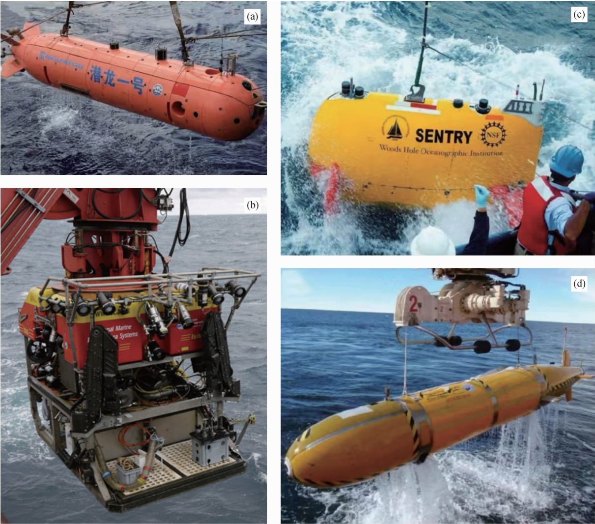
图 1 (a)无人潜水器“潜龙一号”6000 m 自主水下潜水器;(b)英国的无人遥感潜水器 ROV Isis;(c)美国的深海自主水下潜水器 Sentry;(d)英国的深海自主潜水器 Autosub 6000(修改自封锡盛等,2021;Huvenne et al. ,2018)
