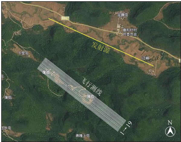
图3 发射源及测线布局图
