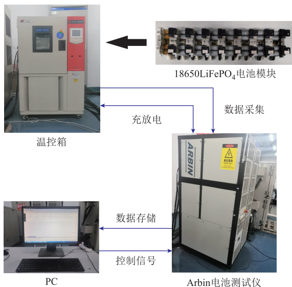
图2 课题组自有电池老化测试平台
