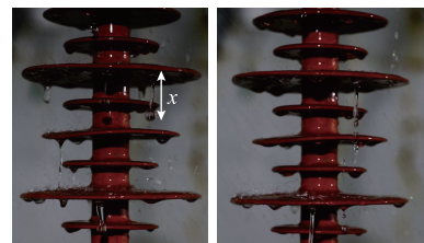
(a) 雨柱断裂前 (b) 雨柱断裂后
