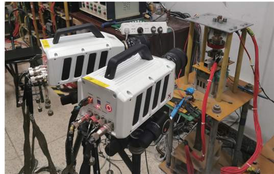
图 1 立体视角中频真空电弧实验系统
