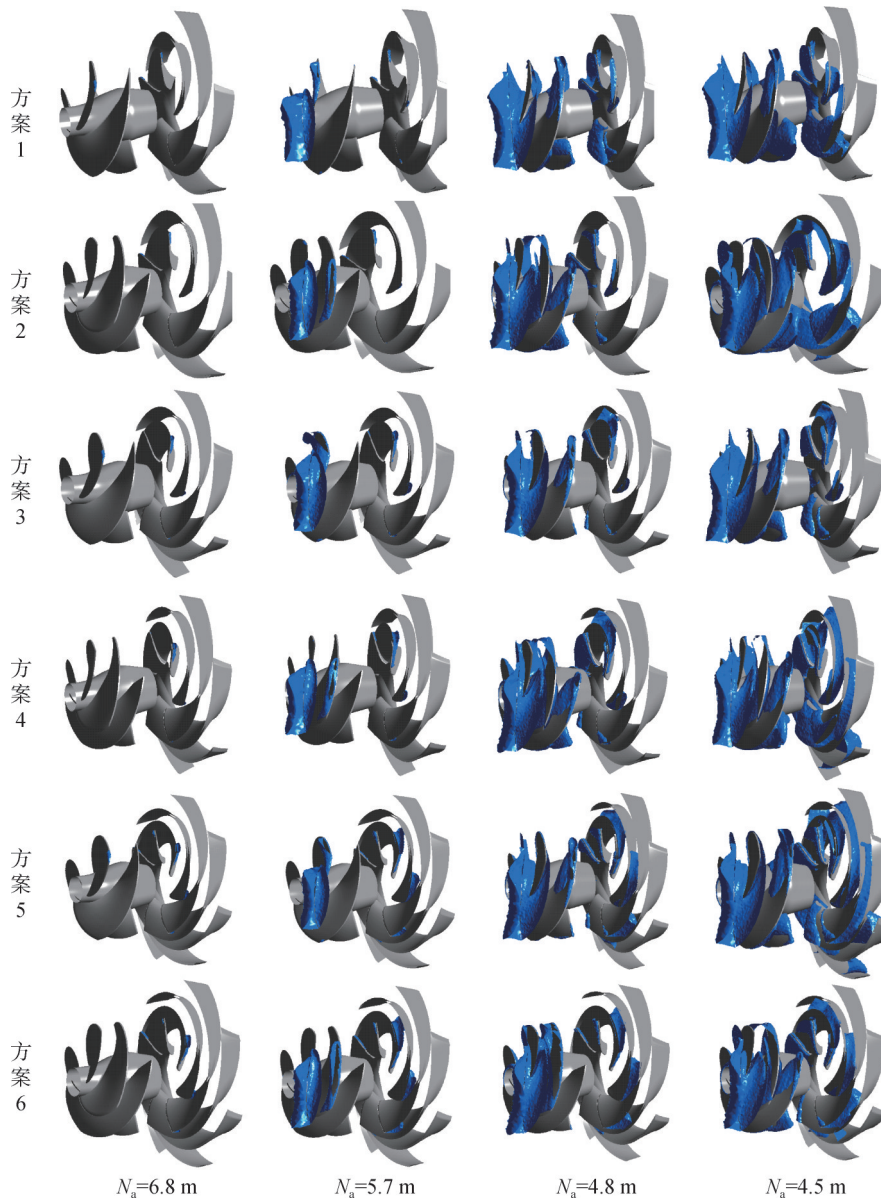
图9 各方案在不同有效空化余量下的空泡分布
