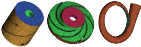
图2 诱导轮、叶轮、蜗壳网格
