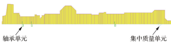
图4 二维梁单元模型
