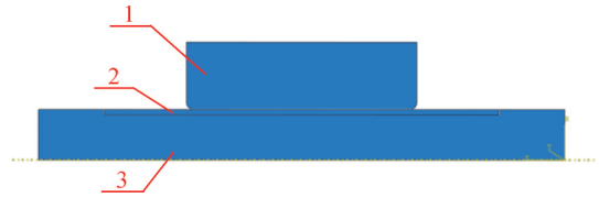
1—金属导向孔;2—非金属衬套;3—金属导向轴。
