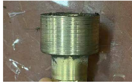
图2 气瓶充气阀寿命试验螺纹滑扣现象
