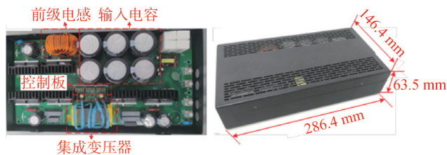
图17 基于矩阵磁集成的隔离型双向DC-DC变换器样机
