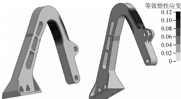
图14 鹅颈削弱后的等效塑性应变云图
