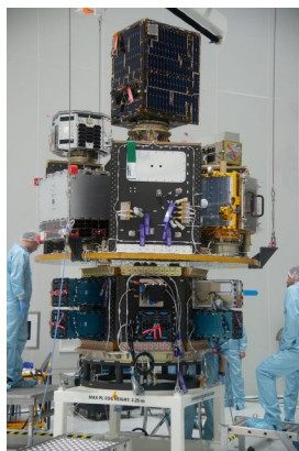
图2 织女星火箭小型航天器任务服务构型
