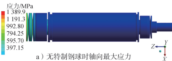
图8 两种减载结构在冲击作用下最大轴向应力云图
