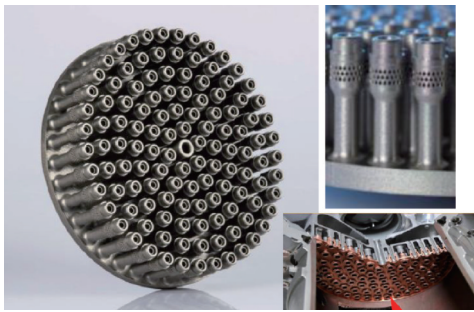
图4 基于SLM技术制备的发动机喷注器
