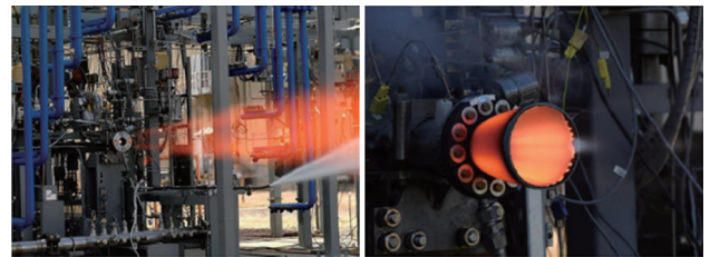
图2 基于SLM技术制备的火箭发动机推力室(包括GRCop-84和C18150合金)
