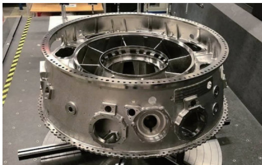
图6 ITP Aero 公司运用 SLM 技术制备的尾座轴承组件
