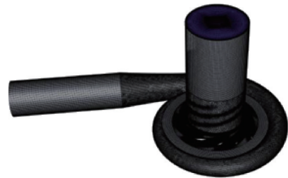
图4 涡轮泵流体域网格
