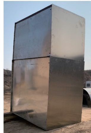
图9 雷达罩等效靶实物
