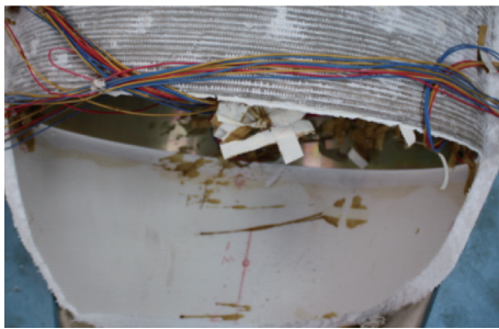
图11 透波罩结构破坏形式
