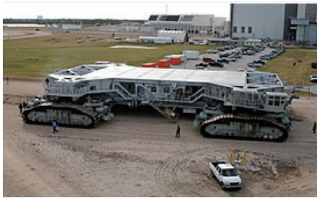
图10 移动发射台的履带式转运车
