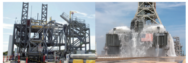
图11 组装前测试与喷水降噪系统测试
