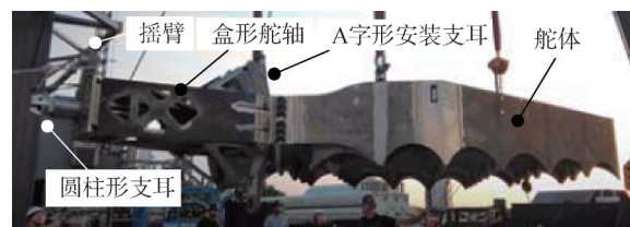
图5 待安装的超重推进级栅格舵
