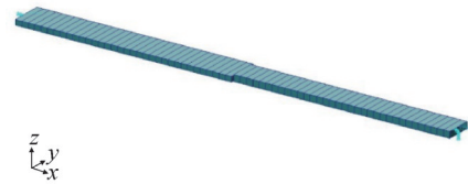
图8 简支梁结构简化建模
