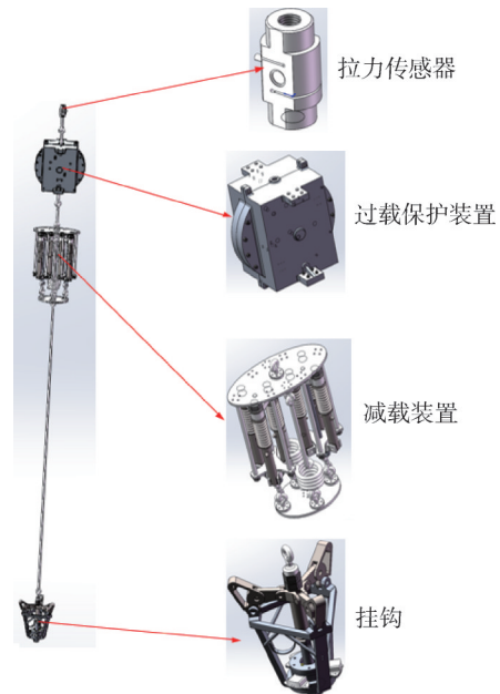
图2 空中回收主挂装置的组成
