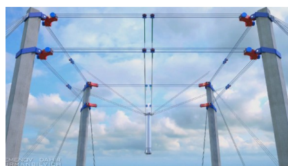
图 12 网系夹持回收概念图
