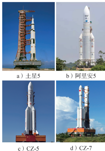
图7 典型“三垂”测发模式运载火箭转运过程
