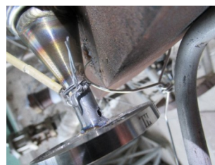
图15 近出口直线段烧穿(方案A)
