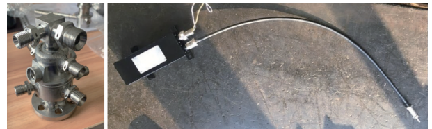
图5 试验产品照片(左:火炬点火室;右:电点火装置)
