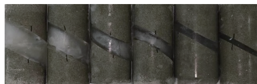
图 3 部分含冰裂隙砂岩试样
