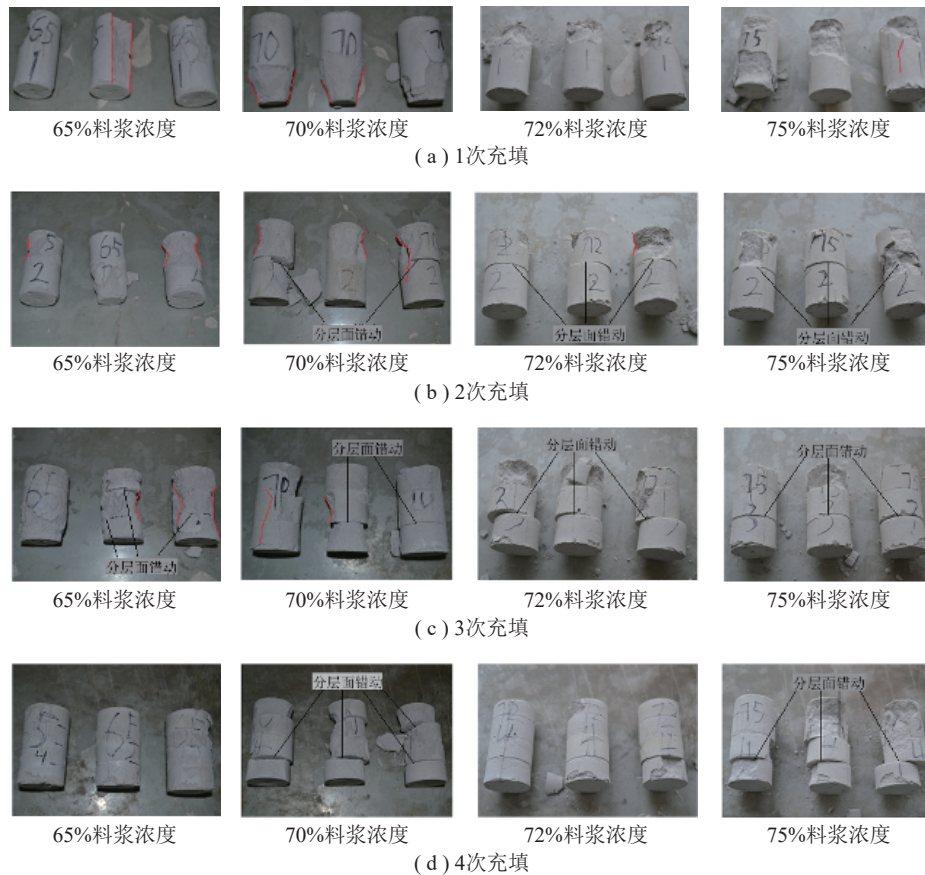
图 11 不同浓度充填体试样破坏形式 [47]
