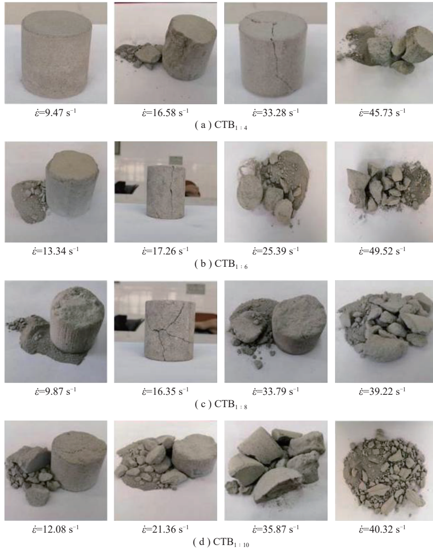
图 5 不同配比充填体破坏模式 [46]
