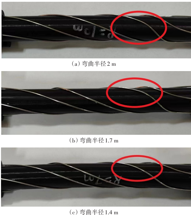
图 23 不同弯曲半径的模型的侧向屈曲(270°相位)
