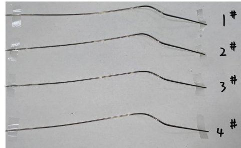
图18 直筒模型钢丝的侧向屈曲形状
