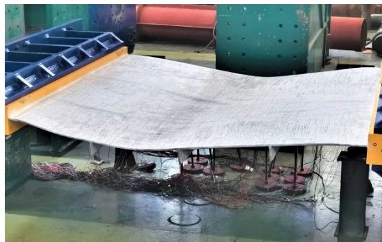
图25 船舶板架最终失效形态
