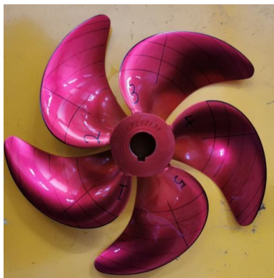
图 1 大侧斜螺旋桨缩比模型
