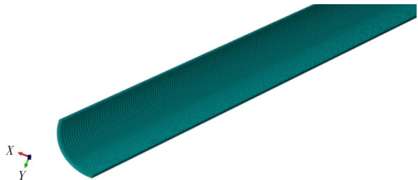
图2 管道有限元模型
