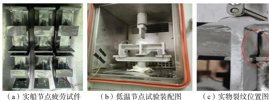
图 12 低温实艇结构节点试验
