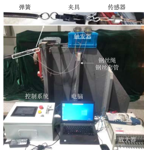
图9 主动式破断模拟装置测试布置
