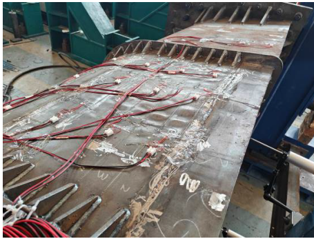
图 17 试验模型舷侧外板屈曲破坏形状
