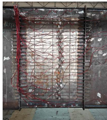
图 16 试验模型甲板屈曲破坏形状
