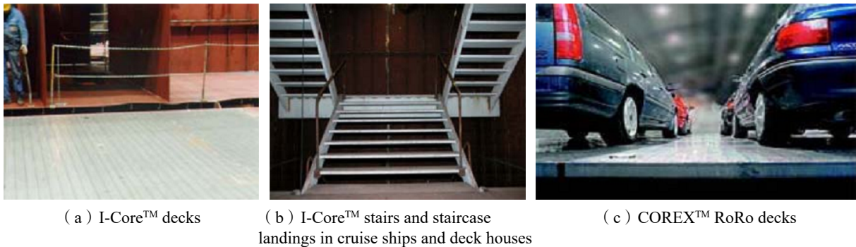
图 1 金属夹芯结构在船体局部结构中的应用 [7] Fig.1 Application of metal sandwich structure in hull local structure [7]
