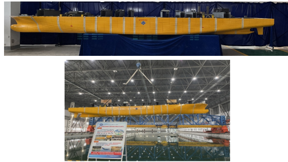
图 1 20 000 TEU 集装箱船水池模型试验
