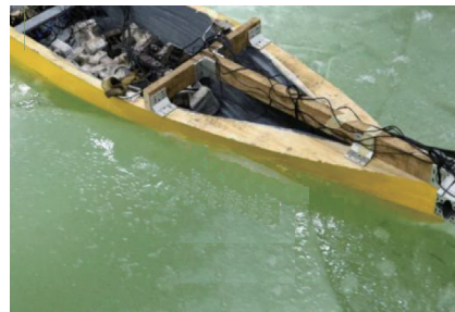
图 7 冰-船碰撞实验 Fig.7 Ship-ice collision test
