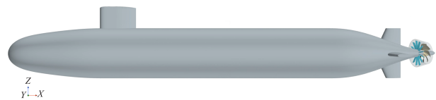
图 6 带大间隙泵喷推进器的 SUBOFF 潜艇模型
