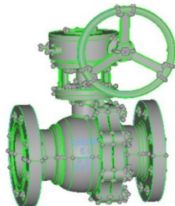
图1 球阀结构模型 Fig.1 Structural model of ball valve
