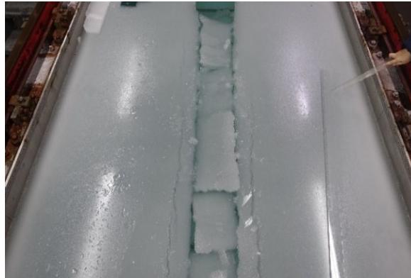
图15 破坏后的冰道(0.05 m/s, 17°工况下)
