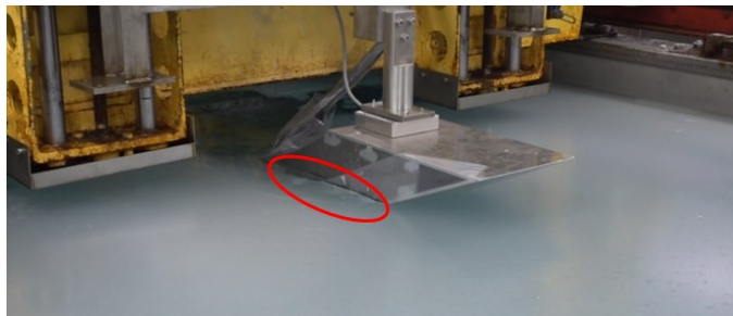
图10 倾斜平面侧面与冰相互作用
