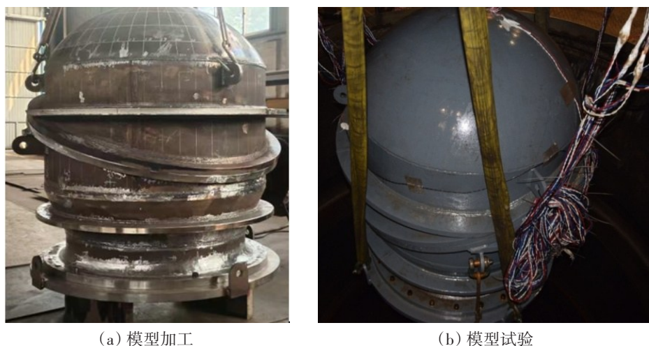
图 13 头盖结构模型试验
