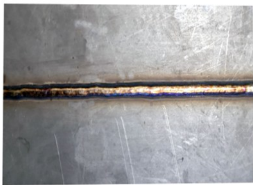
图1 平板对接焊缝示意图
