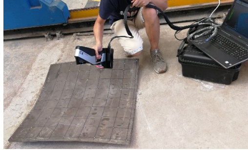
图7 三维激光扫描仪测量数据
