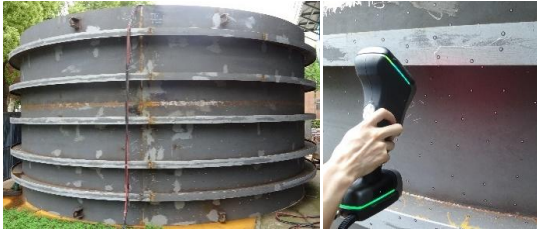
图 18 环肋壳圈模型及扫描过程
