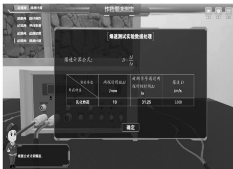
图 7 爆速测定实验结果
