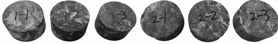
图 1 SHPB 冲击试验部分岩样图
